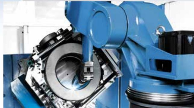
Durch einen vollautomatischen Schweißroboter mit integriertem Mess-System wird die Dichtfläche mit Stellite aufgepanzert. Die CNC Programme werden von hauseigenen Programmierern erstellt. Die Synchronisierung der acht Achsen des Schweißsystems ist dabei eine Herausforderung.
