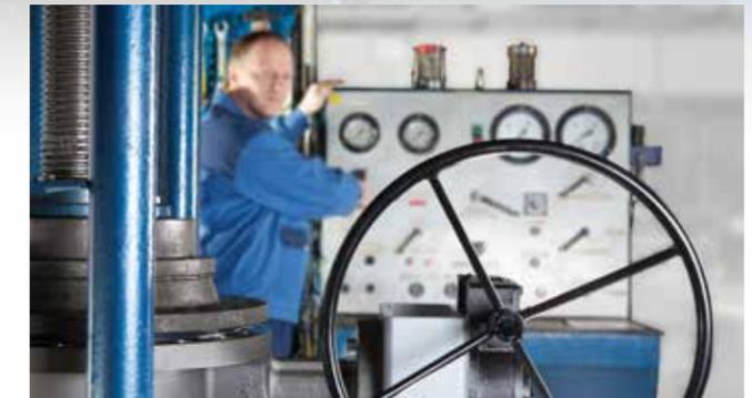
Jede ZETRIX® Prozessarmatur wird gemäß DIN EN 12266 auf Dichtheit geprüft. Prüfdrücke und Prüfzeiten sind im computer-gestützten Prüfstand hinterlegt. Sonderprüfungen sind auf Kundenwunsch möglich.
