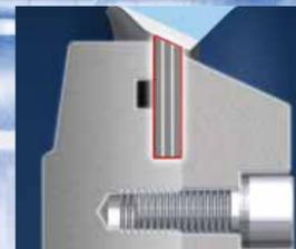
Zusätzliche Elastizität des Dichtrings durch lamellenförmigen Aufbau aus Edelstahl und Graphit. Die Rückdichtung erfolgt mit einer speziell geformten Spiraldichtung aus wärmefestem elastischem Werkstoff.
