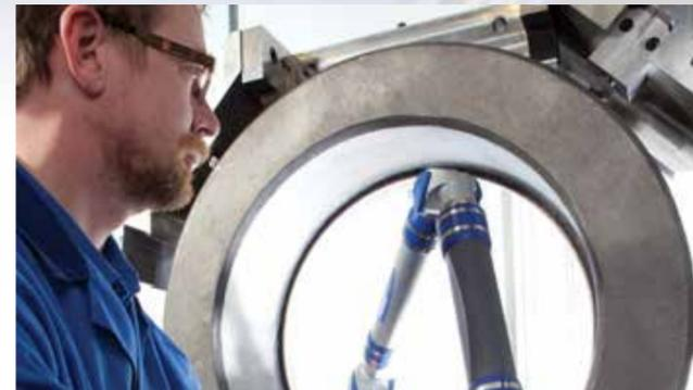
Mit dem dreidimensionalen Mess-System können die Armaturen gegen 3D Daten gemessen werden. Diese werden auf einem PC ausgewertet und gespeichert. Die Messung erfolgt direkt in der Maschine und unterstützt eine prozesssichere Fertigung.
