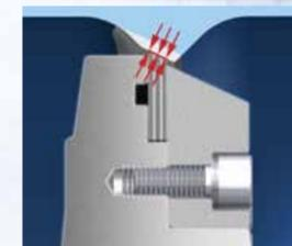
Die ZETRIX® Prozessarmatur dichtet über einen Flächensitz ab, die nötige Flächenpressung wird über den Antrieb aufgebracht, die Abschaltung kann hierbei drehmomentabhängig erfolgen.
