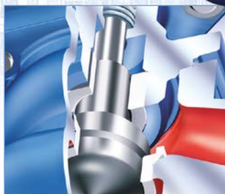
Pour les utilisations sévères (tige anti éjection / clapet guidé sur la tige).
