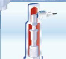
Integrierte Sensorik, Näherungs-Schalter; für die Zustandsüberwachung in der Warte.
