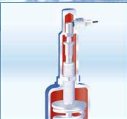
Sensores integrados: sensor de proximidad, utilizado para obtener la señal de alimentación en la sala de control
