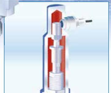
Integrierte Sensorik, Näherungs-Schalter; für die Zustandsüberwachung in der Warte
