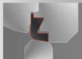
Dicht schließend bis max. +180°C durch PTFE-Dichtring
