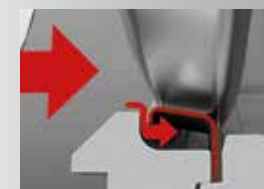
Beidseitig dichtend (bi-direktional) Der Druck des Mediums unterstützt den flexiblen Metall-Dichtring der Scheibe, sodass die Verpressung/Verdichtung in beiden Durchflussrichtungen nahezu gleich ist.
