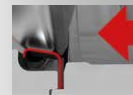
Beidseitig dichtend (bi-direktional) Der Druck des Mediums unterstützt den flexiblen Metall-Dichtring der Scheibe, sodass die Verpressung/Verdichtung in beiden Durchflussrichtungen nahezu gleich ist.
