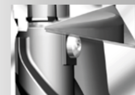
Zusätzliche Sicherheit durch Rückdichtung am Kegel
