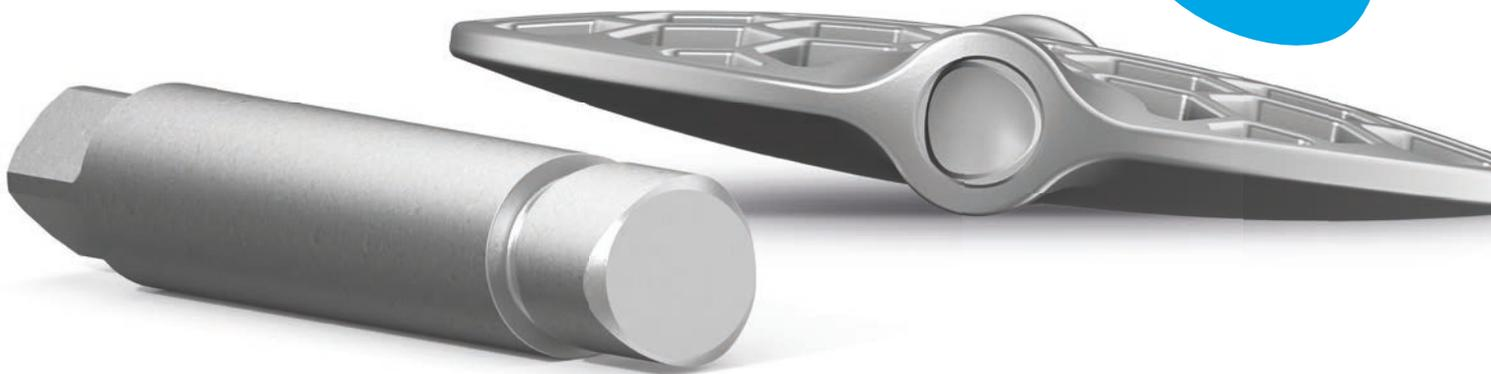
Die Wellen-Scheiben-Verbindung ist für eine optimale Drehmomentübertragung formschlüssig als Polygon ausgeführt. Das Polygon ermöglicht durch seine Selbstzentrierung und dadurch, dass kein zusätzlicher Verbindungstift nötig ist,
