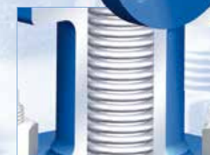
Langlebig durch extra lange, modifizierte, druckfeste Faltenbalg-Ausführung (außerhalb des Medienstroms).
