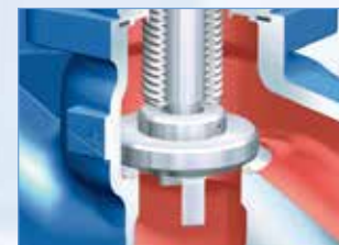
Zusätzliche Spindelführung über den Laternenkegel (höhere Differenzdrücke möglich).
