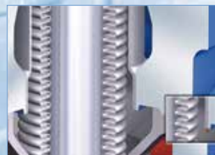
Verstärkter Balg (10.000 Lastspiele) – am Gehäuseoberteil angeschweißt.
