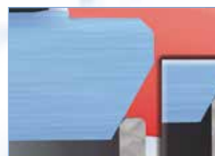
„Cut-Effekt“ – durch konischen Kantensitz werden Ablagerungen vom Sitz „geschnitten“.
