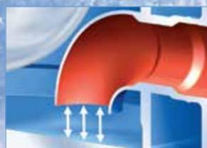
Entrada a poca altura en la tubería de transporte. Para evitar la entrada de vapor en la línea
