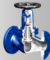
FABBA®: robinets à soupape à soufflet – Clapet conique à "effet couteau" (Ligne d'étanchéité du clapet conique sur son siège).
