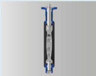
Arbre en deux parties avec triple palier. Extrémité de tige carrée avec indication de position.
