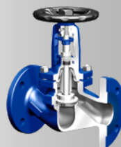
FABA®: das Faltenbalg-Absperrventil mit „Cut-Effekt“ (Linienabdichtung des konischen Kegels auf dem Sitzring).
