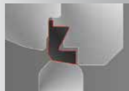
Dicht schließend bis max. +180°C durch PTFE-Dichtring
