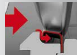
Beidseitig dichtend (bi-direktional) Der Druck des Mediums unterstützt den flexiblen Metall-Dichtring der Scheibe, sodass die Verpressung/Verdichtung in beiden Durchflussrichtungen nahezu gleich ist.
