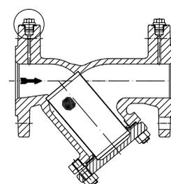
Bohrungen für Differenzdruckmessung
