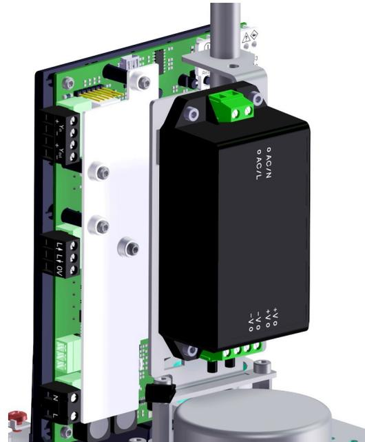
Bild 13: Einbau und Anschluss Netzteil
