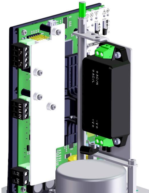
Bild 12: Einbau und Anschluss Netzteil
