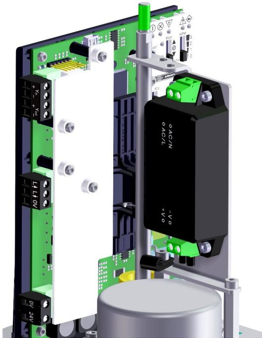
Bild 30: Einbau und Anschluss Netzteil
