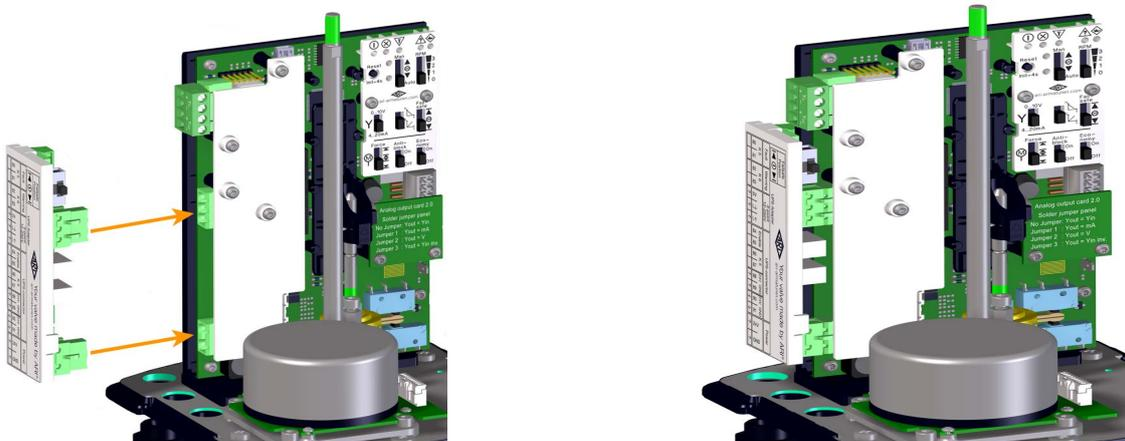
Bild 38: Einbau der UPS-Adapterplatine
