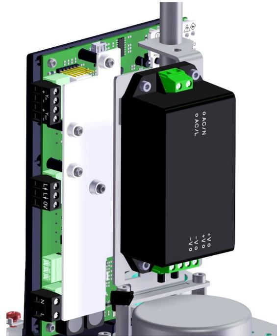
Bild 31: Einbau und Anschluss Netzteil
