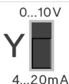
Nur wenn bei der Initialisierung ein analoges Eingangssignals am Analogeingang erkannt wurde, kann der Stellantrieb auch über ein analoges Eingangssignals angesteuert und ein Ausfall des  $Y_{in}$ -Signales erkannt werden!
