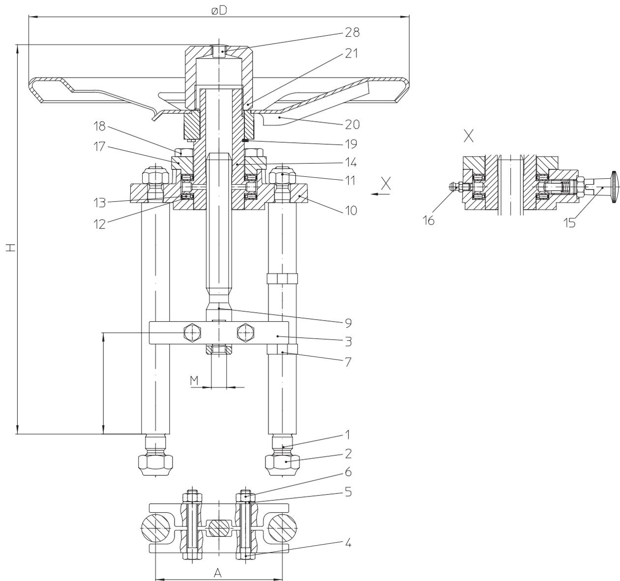
Le volant est bloqué par le dispositif de blocage (15) qui empêche la rotation du volant. Pour faire tourner le volant, il faut commencer par retirer le dispositif de blocage. Lubrifier avec de la graisse en utilisant le graisseur (16).
