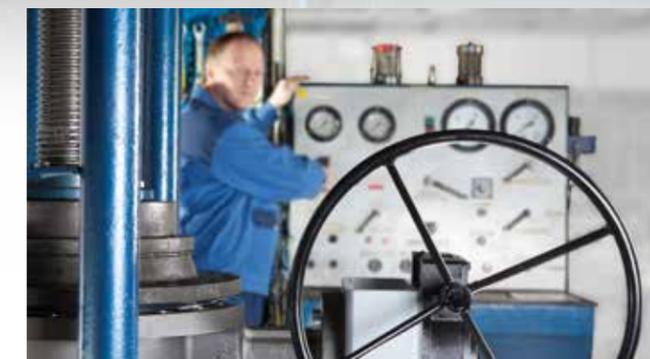
Jede ZETRIX® Prozessarmatur wird gemäß DIN EN 12266 auf Dichtheit geprüft. Prüfdrücke und Prüfzeiten sind im computer-gestützten Prüfstand hinterlegt. Sonderprüfungen sind auf Kundenwunsch möglich.
