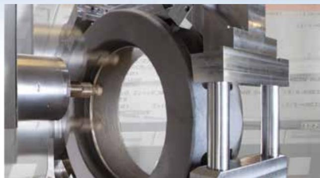
Die Gehäuse werden auf vollautomatischen CNC-gesteuerten Bearbeitungszentren gefertigt. Die CNC Programme werden auf Basis von CAD Daten erstellt und online in die Steuerung überspielt. Die Bearbeitung erfolgt in einer Aufspannung. Hierfür speziell entwickelte Vorrichtungen garantieren höchste Stabilität bei der Bearbeitung und schnelle Rüstzeiten.
