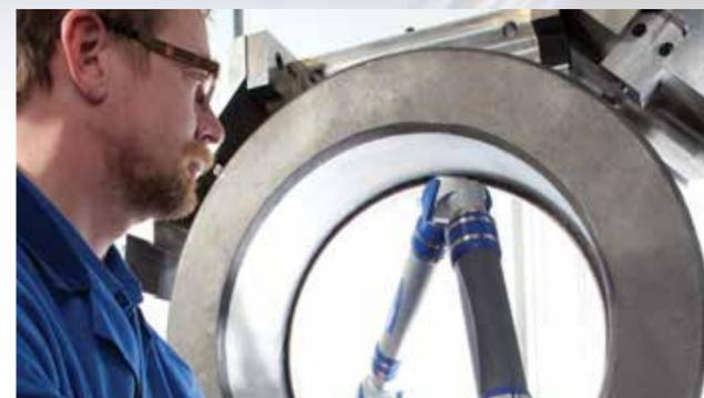
Mit dem dreidimensionalen Mess-System können die Armaturen gegen 3D Daten gemessen werden. Diese werden auf einem PC ausgewertet und gespeichert. Die Messung erfolgt direkt in der Maschine und unterstützt eine prozesssichere Fertigung.
